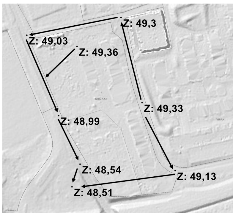
Pilarna visar i vilken riktning vatten på markytan tar. Siffrorna anger aktuella marknivåer.
