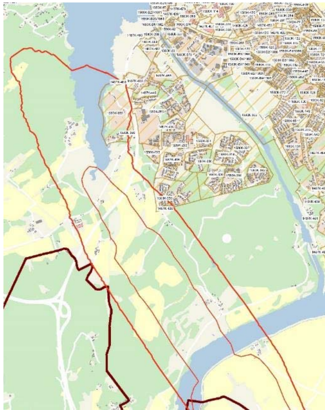
Flygbullerkurvan är satt efter 3 överskridningar per dygn (yttre linje) och 16 överskridningar per dygn (inre linjen) där området innanför respektive markeringen överskrider 70dB.
