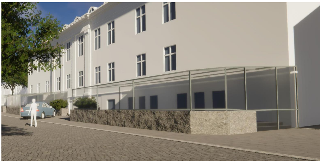
Bilden illustrerar hur terraseringen fångar upp Hamngatans lutning. På ena sidan angörs uteserveringen med hjälp av en trappa och på andra sidan med en ramp.
