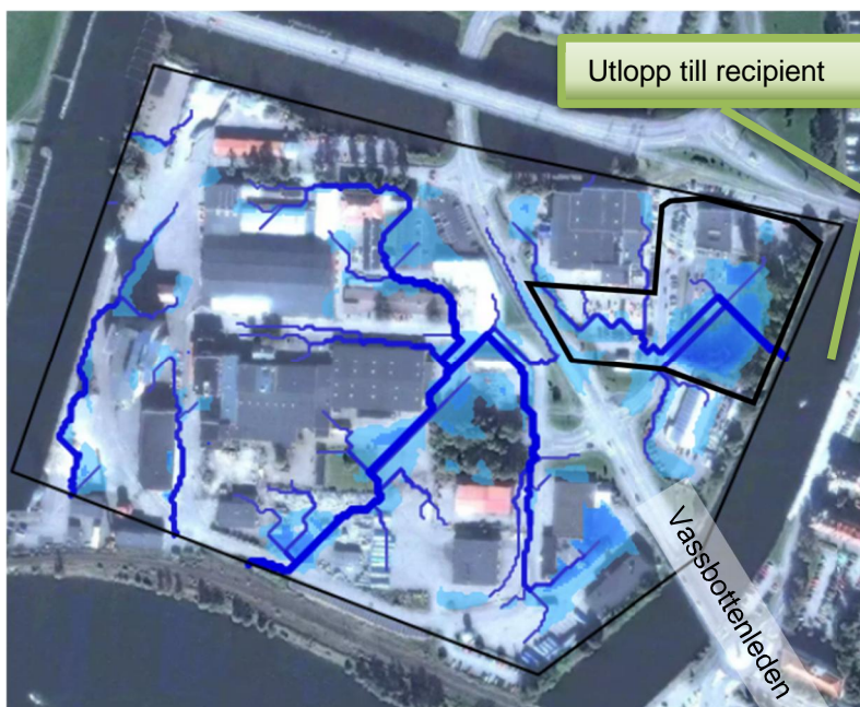
Figur 7 Ytliga avrinningsstråk visar med blåa streck och instängda område med blå yta. ScalgoLive 20200824
